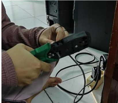
Gambar 3. proses crimping untuk pembuatan kabel LAN
