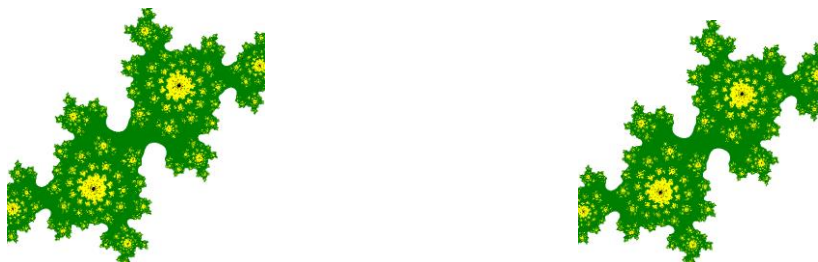
Citra Sampul Himpunan Julia Z^2-(0,282,0,666) Citra Stego setelah disembunyikan pesan 16000 bit RMSE = 0,57; PSNR = 72,99
