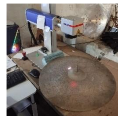
Gambar 18. Proses Grafir (Sumber: Dok. Pribadi, 2024)
