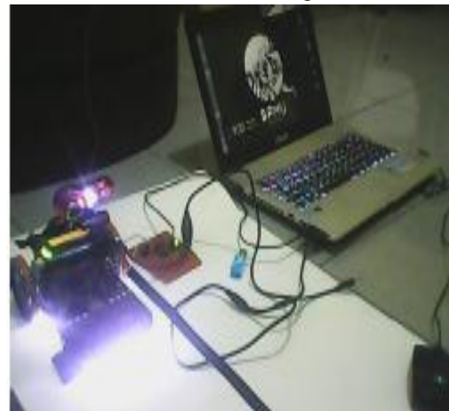
Gambar 11: aplikasi transformasi Hough pada robot lane tracking
