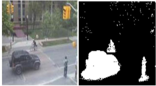
**Gambar 4a:** Segmentasi objek bergerak dengan algoritma GMM
