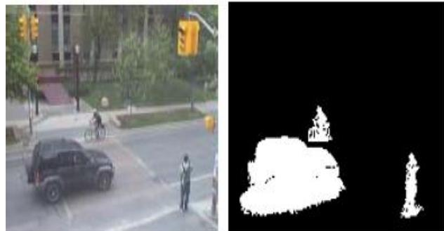
**Gambar 4b:** Segmentasi objek bergerak dengan algoritma PCA-GMM
