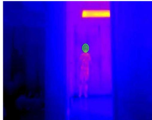
**Gambar 3c:** Hasil pendeteksian objek dengan thermal point cloud ketika objek masuk dalam ruangan berkabut/berasap.
