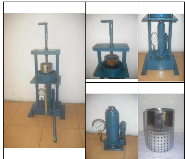
Gambar 5: Alat press hidrolik buah nyamplung
